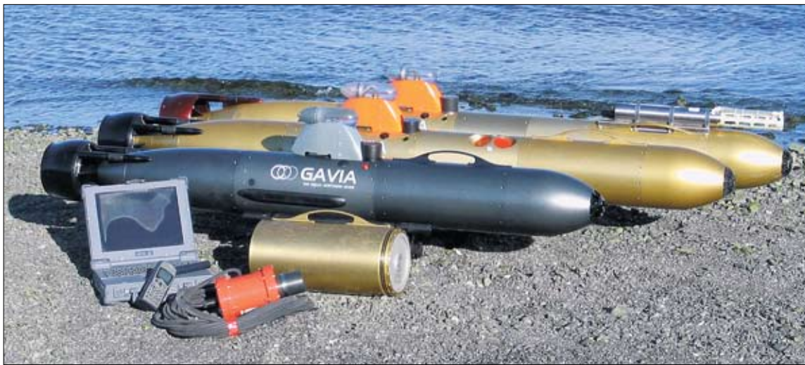
Kafbátarflotinn er markaðssettur undir nafninu Gavia en „Gavia immer“ er latneska heitið á himbrima. Fremsti báturinn (sá grái) er grunnfar, þá kemur samsetning fyrir hermarkaðinn og aftast er djúpfar sem er samsett fyrir umhverfirannsóknir.
